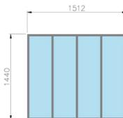
Chassis réalisé en fer T
