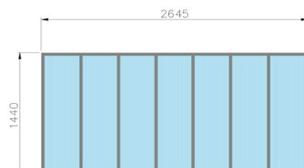
Chassis réalisé en fer T
