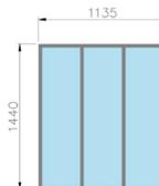
Chassis réalisé en fer T
